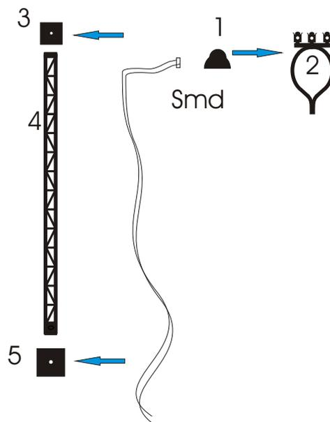
2-Souder l'une sur l'autre les supports du globe, et souder le globe.
